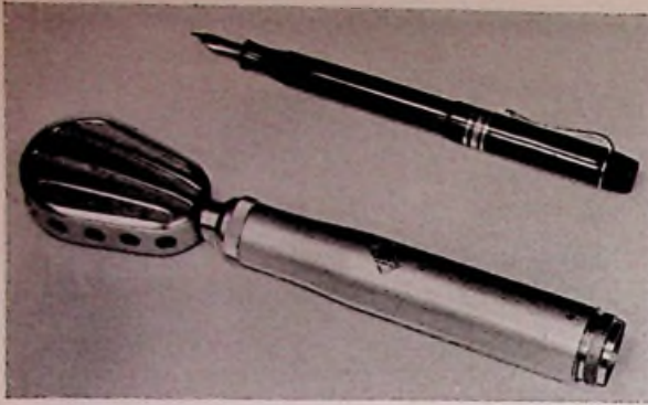
Bild 9 a: Telefunk-Kondensatormikrofon — System Dr. Schoeps — für Rundfunk- und Fernsehstudios.
