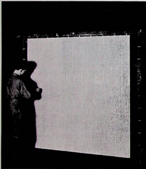
Bild 3: Aus 10000 Glühlämpchen zusammengesetzte Karolus-Wabentafel.
