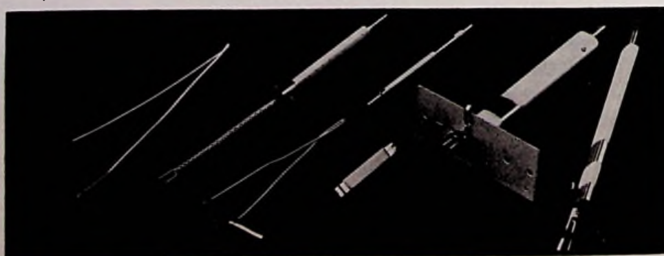
Bild 9: Verschiedene Kathoden. Von links nach rechts: Nickelbandkathode, Rundkathode Bifilarbrenner (Kehrwende, der AF 7), Rundkathode mit Bifilarbrenner (Doppelkehrwendel einer Pico-Röhre), Profilkathode einer Pico-Röhre, zwei Profilkathoden von Endröhren.
